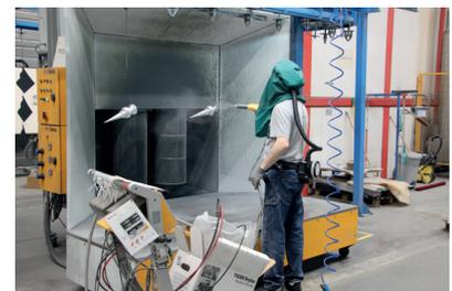
Les accessoires sont eux poudrés sur une petite cabine manuelle **ClassicOpen** équipée d'un manuel Gema **OptiFlex1 B**.
