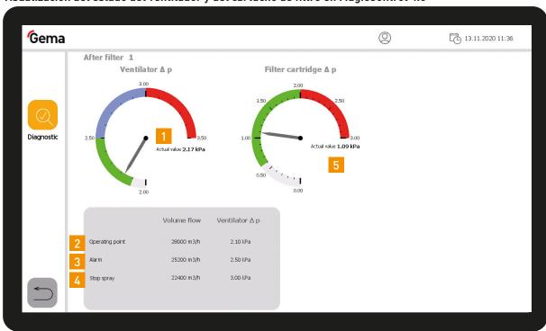
Visualización del estado del ventilador y del cartucho de filtro en MagicControl 4.0
